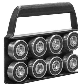
В корпусе расположены два торцевых (поперечных) ролика (подшипника), которые позволяют не царапаться заготовке окрашенного металла с торца (в отличие от фальцезакаток, в которых предусмотрены пластины из пластмассы – вылетающих от стенки корпуса или со временем перерезаемые насквозь).
