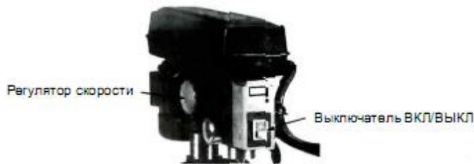
**НЕ РЕГУЛИРОВАТЬ СКОРОСТЬ СВЕРЛЕНИЯ ВО ВРЕМЯ ОСТАНОВКИ ИЛИ ЗАМЕДЛЕНИЯ СТАНКА. РЕГУЛИРОВАТЬ СКОРОСТЬ ТОЛЬКО ПРИ РАБОТЕ СТАНКА.**
