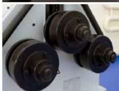
Ролики имеют возможность регулировки ширины
