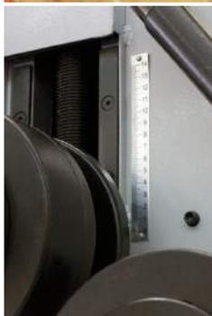
Вдоль перемещения верхнего ролика на станке установлена шкала повторяемости
