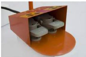
Стойка управления с двумя ножными педалями для вращения приводных роликов в обе стороны
