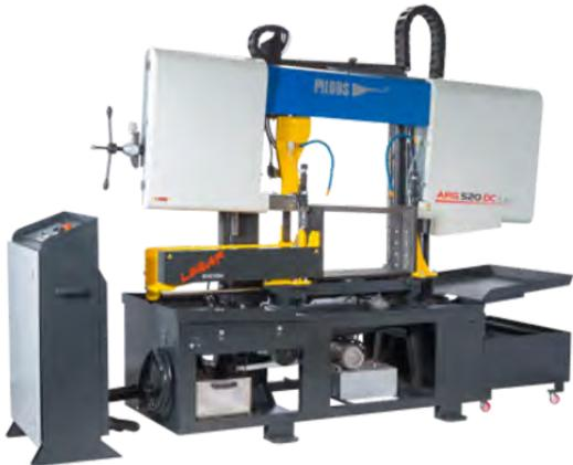
Оптимальный зажим заготовки при пилении реализован за счет использования длинноходных тисков. Перемещение тисков происходит по линейным направляющим. Подвижная направляющая пилы перемещается синхронно с губками тисков, что обеспечивает минимальный зазор между направляющей и заготовкой и, как результат, высокую скорость и точность пропила. Перемещение блока также происходит по линейным направляющим.
