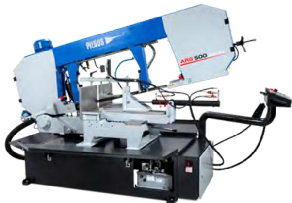
Полный цикл пиления запускается при нажатии одной кнопки – происходит зажим материала, включение вращения пилы и подачи СОЖ, распила, выключения пилы и СОЖ, подъем рамы в исходное настраиваемое положение и разжим тисков. Все это, при наличии управляемой гидравлической подачи, позволяет получить максимальную производительность, особенно при пилении больших серий или пилении труднообрабатываемых материалов сплошного сечения.
