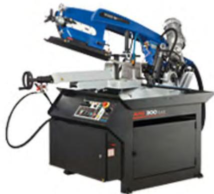
Станок оборудован высокопроизводительным промышленным гидроагрегатом. Полный цикл пиления запускается при нажатии одной кнопки – происходит зажим материала, включение вращения пилы и подачи СОЖ, распила, выключения пилы и СОЖ, подъем рамы в исходное настраиваемое положение и разжим тисков. Все это, при наличии управляемой гидравлической подачи, позволяет получить максимальную производительность, особенно при пилении больших серий и пилении труднообрабатываемых материалов сплошного сечения.
