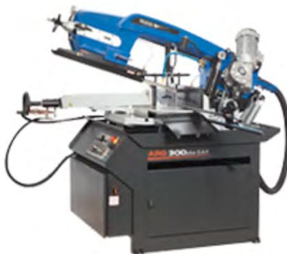
При переключении в ручной режим, можно управлять всеми функциями станка по отдельности. Благодаря наличию гидростанции, тиски могут регулироваться по усилию прижима. Высокие показатели производительности достигаются также вследствие использования частотного регулирования приводом вращения пилы, что позволяет плавно регулировать скорость резания от 15 до 90 м/мин, что также многократно увеличивает точность реза и стойкость ленточной пилы.
