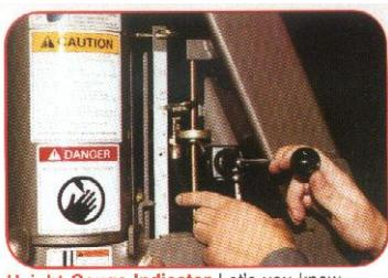
Указатель на направляющей: Указывает рабочее положение, а также служит точкой отсчета для будущей работы
