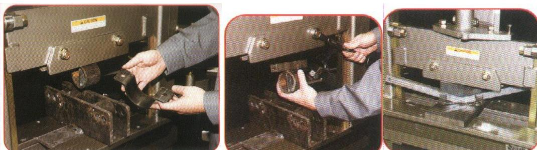
При опускании верхнего лезвия пресса оно должно быть параллельно рабочему столу. Для поддержания точности прессования и сгибания предусмотрена задняя направляющая колонна (пресс-форма) для кронштейна верхнего лезвия
