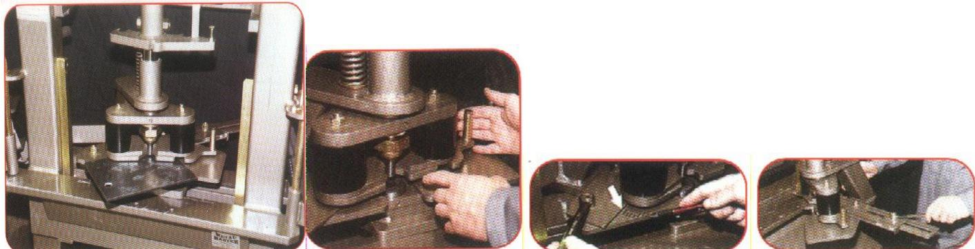
Полиуретановое независимое устройство имеет две функции: зажим детали, чтобы избежать деформации и выход из машины.
