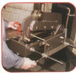
Очень простой в эксплуатации, большой стол для резки на удобной высоте 1003 мм, со специально разработанным зажимом обеспечивает простоту установки и крепления детали.
