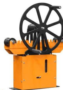
Прижим обеспечивает гидравлический домкрат грузоподъемностью 5 тонн. Прижимные быстросъемные ролики перемещаются горизонтально для гибки на любой радиус, а также для работы с малыми заготовками. Толщина стенки профильной и круглой трубы 1,5 мм. Профильная труба – макс. размер 60x40мм, круглая труба – макс. размер Ø30мм, квадрат - все размеры до 20мм, круг – все размеры до 20мм.
