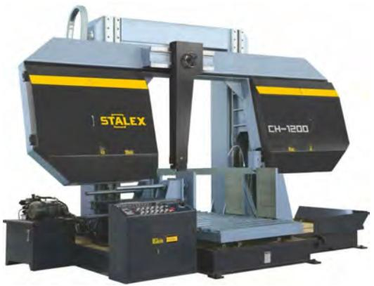
Полуавтоматический ленточнопильный станок, предназначен для пиления труб и сплошных заготовок, максимальным диаметром круга 1000мм / 1200мм и прямоугольной заготовки 1000x1000мм / 1200x1200мм под углом 90°.
