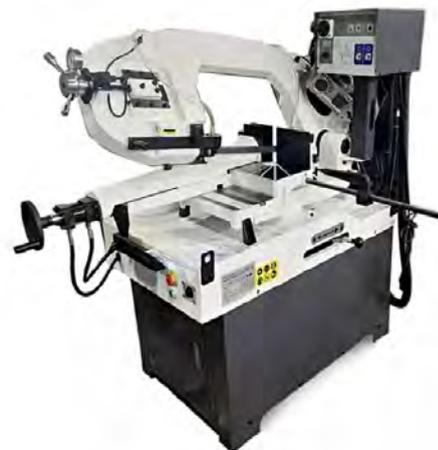
STALEX BSM-270GA (102617) — это мощный ленточнопильный станок, предназначенный для эффективного пиления заготовок под различными углами. Он идеально подходит для работы с заготовками диаметром до 270 мм и прямоугольными профилями 220x370 мм. STALEX BSM-270GA (102617) является надежным и высокоэффективным станком для распила различных заготовок. Его особенности и продвинутая комплектация позволяют достичь отличных результатов при пилении материалов различных типов и
