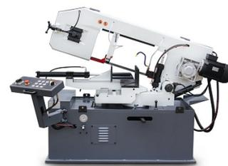
На полуавтоматических станках возможна работа как в ручном режиме, когда каждая операция выполняется вручную посредством нажатия соответствующей кнопки, так и в автоматическом режиме, когда станок выполняет весь цикл резания (зажим заготовки – запуск пилы – опускание рамы – остановка пилы – подъем рамы – отжим тисков). В последнем случае оператор должен лишь обеспечить подачу заготовок и нажатие кнопки «Пуск»
